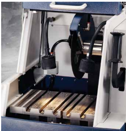
Trenntisch aus Edelstahl ohne Zustellung der X-Achse
