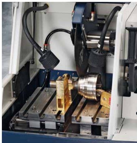
Schnellspanner zum Spannen unregelmäßiger Teile
