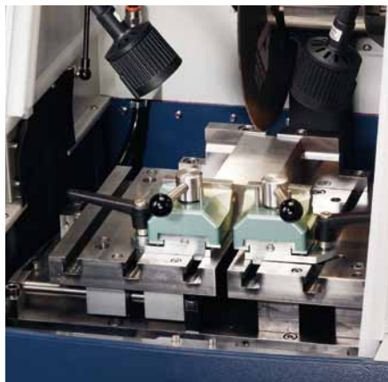
Schnellspannvorrichtung mit getrennten Backen
