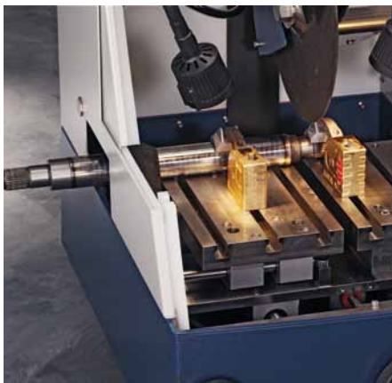
Seitliche Öffnung zum Trennen langer Teile
