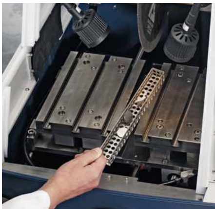
Korb zum Auffangen von kleinen Trennteilen
