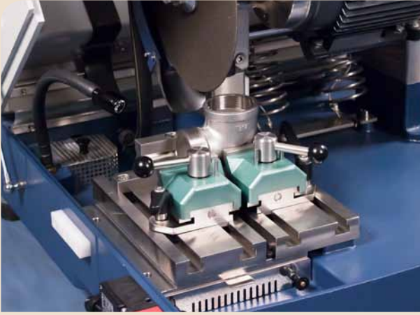
Schnellspannvorrichtung mit getrennten Backen (10-2170, links und 10-2171, rechts) als funktionale Lösung für die meisten Proben.
