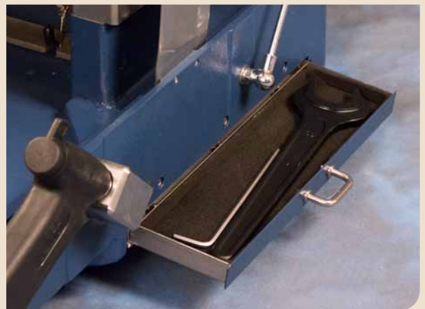
Eine Schublade befindet sich seitlich im Gehäuse der AbrasiMet. Hier können Sie alle Werkzeuge, die beim Betrieb des Gerätes benötigt werden, verstauen.
