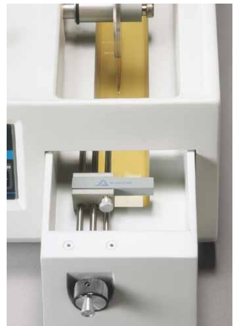
Der Behälter für Kühlmittel ist leicht zugänglich und enthält die Abrichtvorrichtung für die Trennscheibe.
