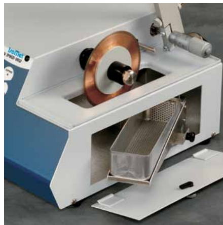
Der Behälter für Kühlmittel ist leicht zugänglich und kann seitlich ausgeschwenkt werden
