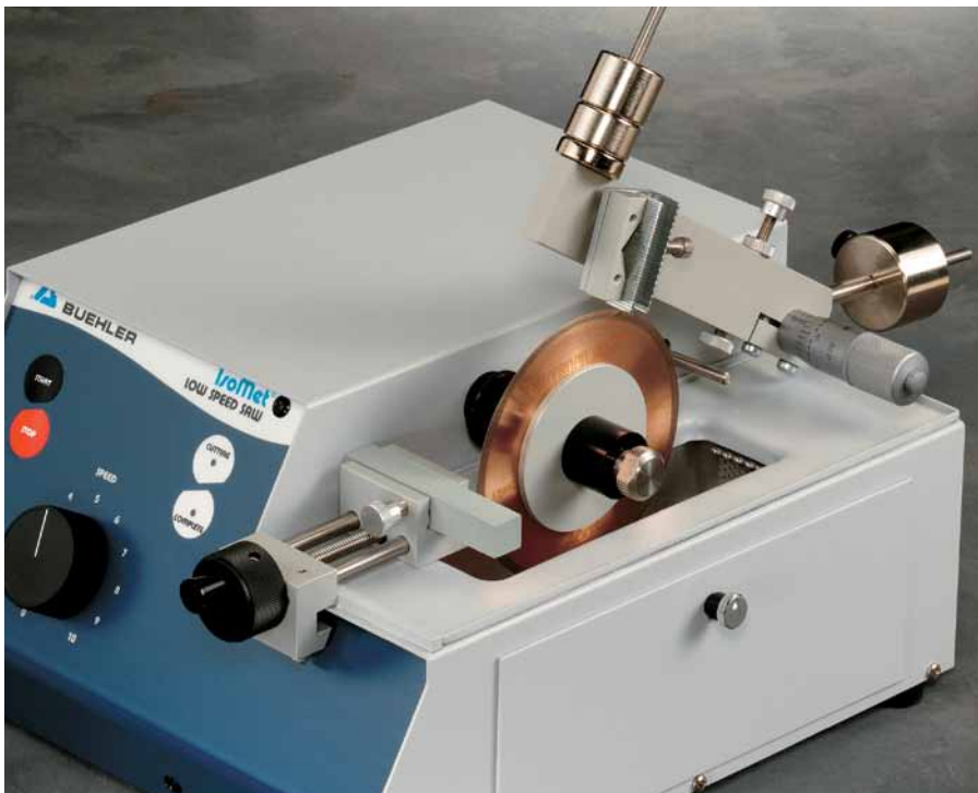
Die Probe wird mittels Schwerkraft gegen die Trennscheibe geführt. Die Belastung kann in 25 g Stufen eingestellt werden. Die Mikrometerschraube am Probenhalterarm erlaubt das präzise parallele Zustellen der Probe.
