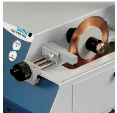
Die Haltevorrichtung für einen Abrichtstein (11-1196) erlaubt das Abrichten der Trennscheibe während des Trennvorgangs
