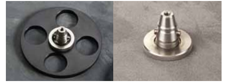
l: Einzelanddruck-Probenhalter für Vector LC 250 r: Probenhalterzapfen für Einzelanddruck Vector LC 250
