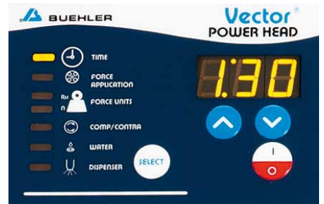
Bedienfeld des Vector Automatikaufsatzes – Folgende Präparationsparameter können eingestellt werden: Zeit, Druck (N oder lbs), Gleich-/Gegenlauf, Wasser Ein/Aus, Dosierung (PriMet Satellit Ein/Aus)
