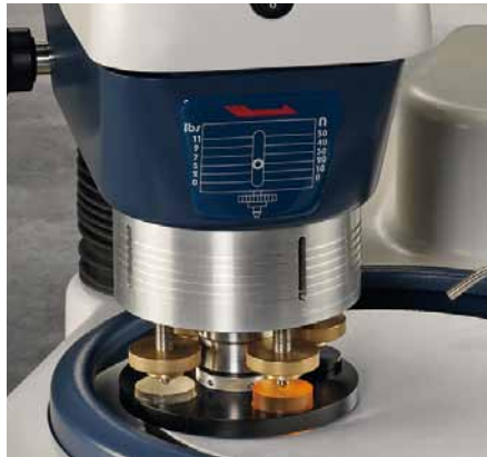
Vector LC 250 mit Einzelandruck-Probenhalter. Präparationsdruck wird über die Rändelschrauben eingestellt und kann an der Gravierung abgelesen werden.
