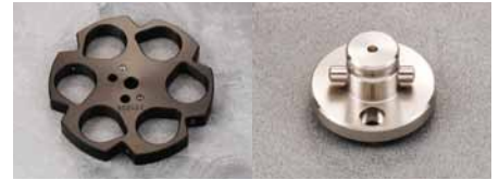
l: Zentralanddruck-Probenhalterscheibe für Vector r: Probenhalterzapfen für Zentralanddruck Vector
