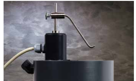
Der Behälteraufsatz der Elektrolysezelle ist auch Auflagetisch für die Probe. Leicht auswechselbare Masken gestatten die Präparation unterschiedlich großer Probenflächen.
