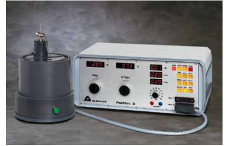
Der PoliMat 2 besteht aus zwei Komponenten, der Stromversorgungseinheit und der Elektrolysezelle. Die Stromversorgungseinheit ist in einem stabilen Metallgehäuse untergebracht. Die Präparationsparameter sind getrennt einstellbar.
