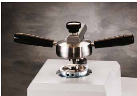
Sicheres Arbeiten durch Bajonettverschluss
