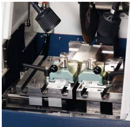
Etou inox à serrage rapide et mors séparés.
