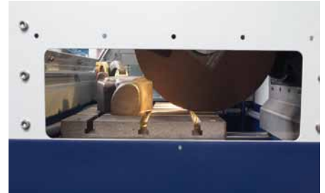
Les ouïes transparentes latérales peuvent être enlevées pour le passage des pièces longues
