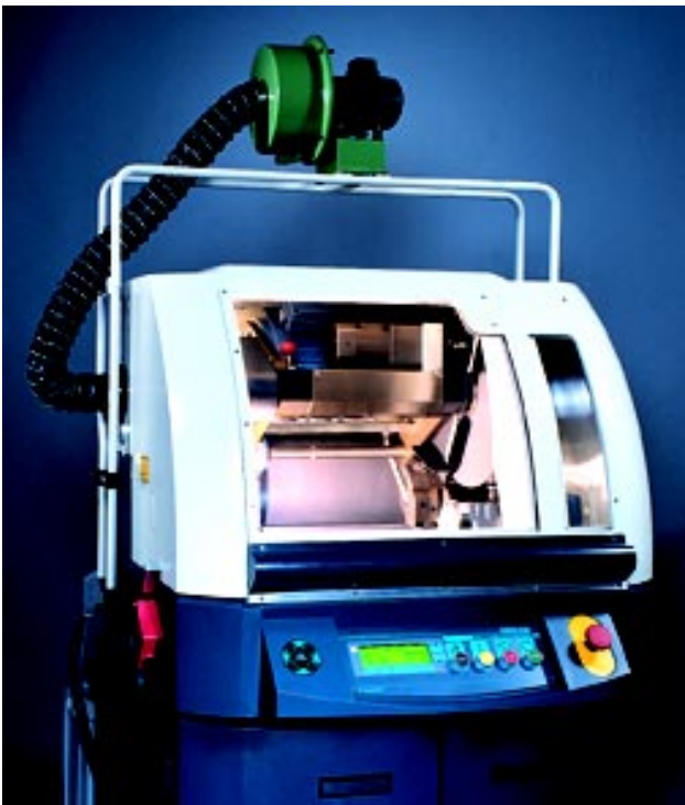
Die Absauganlage 10-2342 saugt den im Trennraum entstehenden Nebel ab, filtert ihn und reduziert unerwünschte Emissionen.
