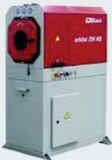
Die Eingangsöffnung lässt sich der Materialgröße anpassen: Bürstenentgrater „Orbital 250 N II“. Bild: Bomar
